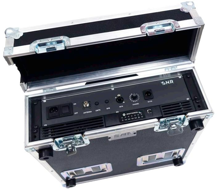
ST.RI.T. è una soluzione dual-mode (Analogico/ DMR) e può essere assemblata sia con la stazione ripetitrice SLR5500 di Motorola Solutions che con il ripetitore Kairos di Radio Activity.
