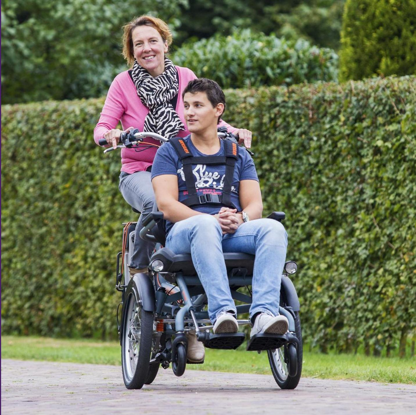
**La Opair come la Veloplus nasce per il trasporto di persone con disabilità motorie. Ma l'innovazione di questo modello sta nel fatto che anziché caricare carrozzine, ha la carrozzina incorporata nel proprio telaio.**
