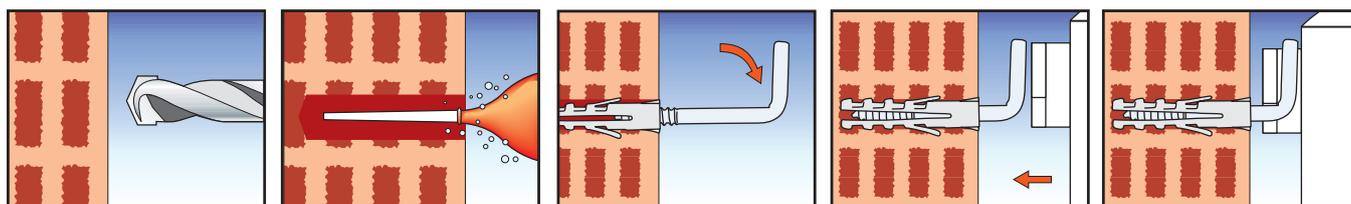
Si raccomanda un'accurata pulizia del foro prima dell'installazione
