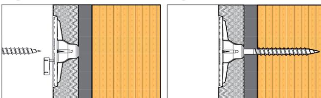
Il serraggio della vite autofilettante o a percussione, inserita nella sede centrale del disco crea la giusta pressione per il fissaggio dell'isolante.
