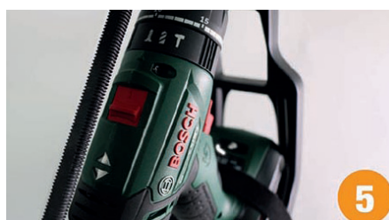
Regolare la velocità del trapano su 1
