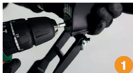
Inserire il trapano nell'ugello esagonale e serrare il mandrino
