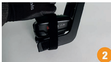
Serrare la base del trapano con la cinghia
