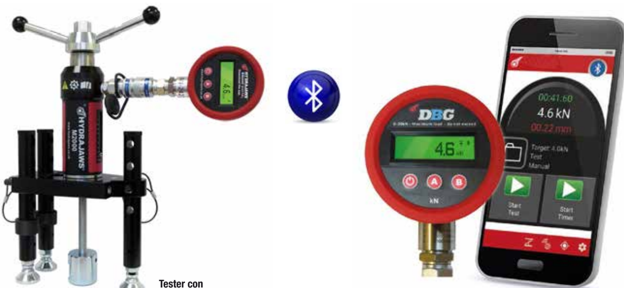
Tester con manometro digitale
