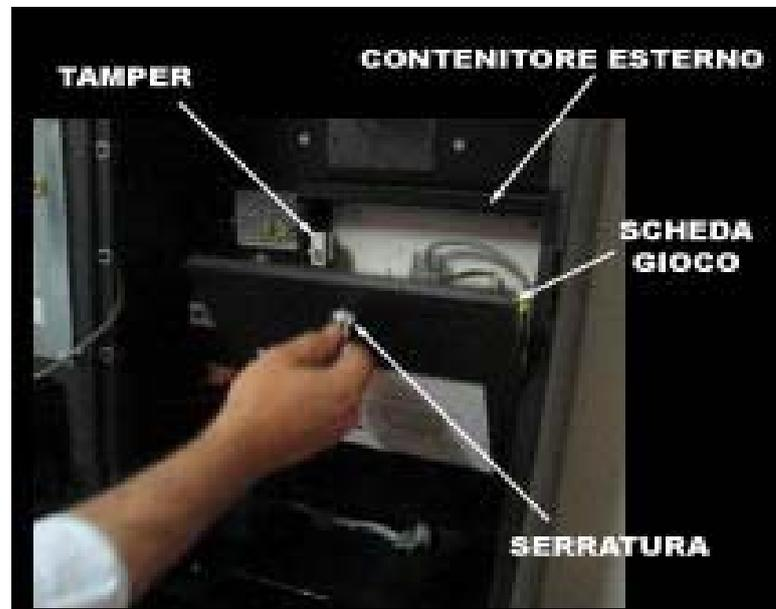
Nome del mobile alternativo Mod. GLAMOUR – Produttore: Cristaltec S.p.A.
