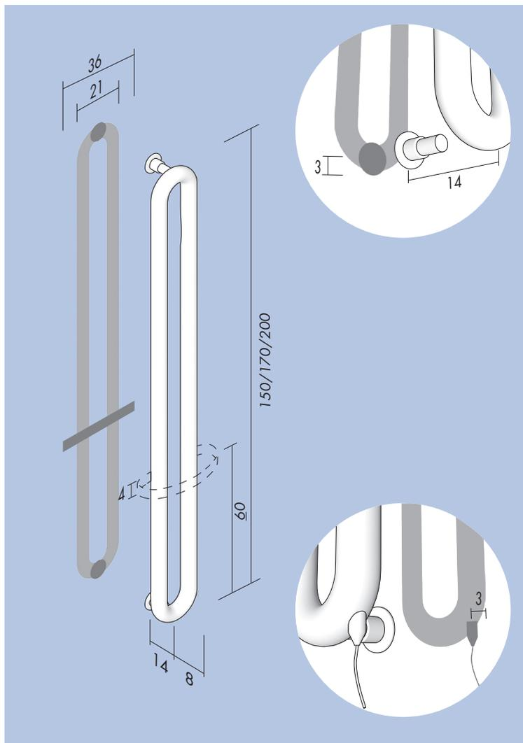
Electric with schuko plug / Version électrique avec prise schuko / Elektromodell mit schukosteckdose / Versión eléctrica con enchufe schuko
