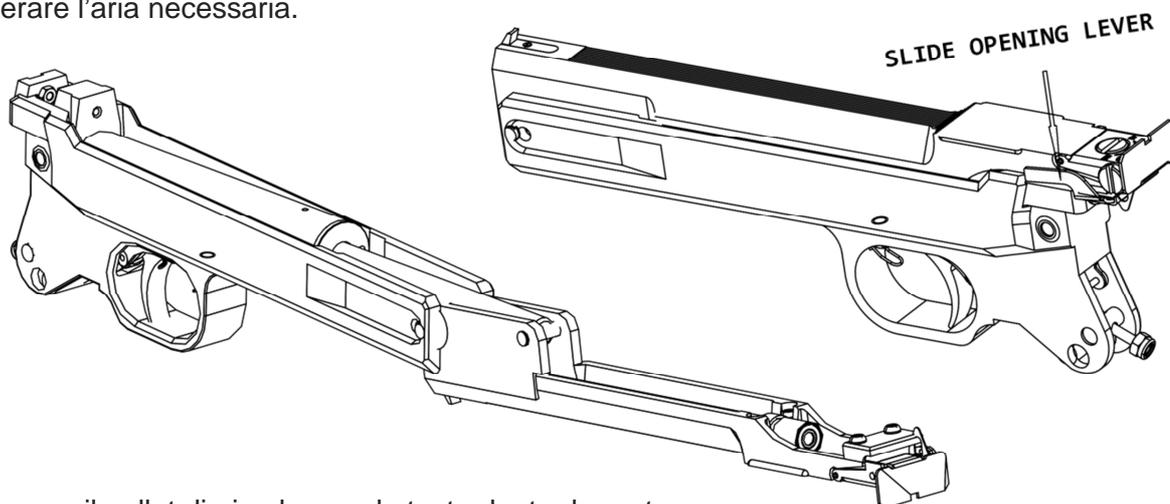
Posizionare il pellet di piombo con la testa dentro la parte della canna. Assicuratevi che il pellet sia a filo con la culatta.
